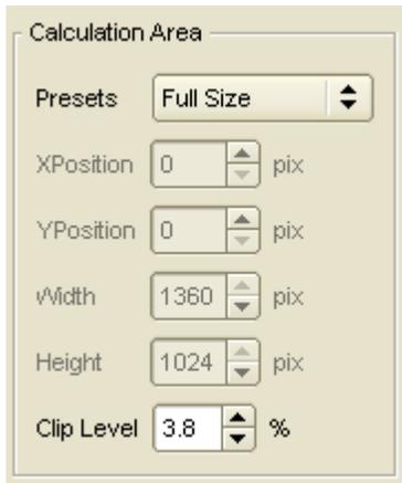
在章节 [应用设置](#) [58] 中可设置计算区域。在光束质量测量 ( $M^2$  或发散) 中一直开启了自动计算区域以有效减小噪声。并且选择靠近光束剖面的自动计算区域可抑制滤光片、透镜或其它光学元件的反射和自身引入的噪声。
