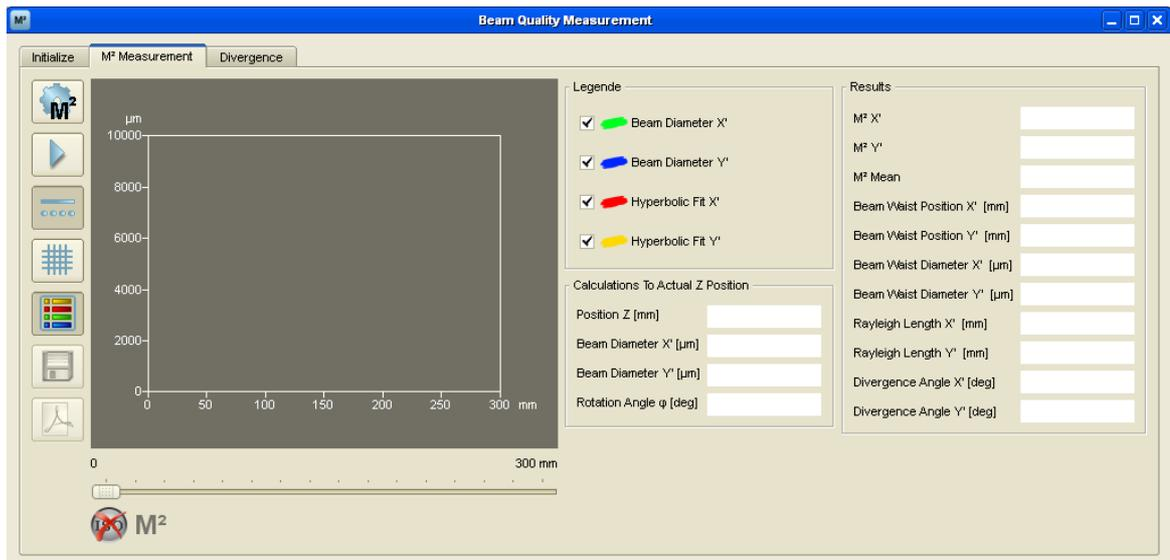
$M^2$ 测量到的数据会显示在这个标签页里。如果这个程序探测的是(未聚焦的)线性传播光束而不是(聚焦的)双曲线光束，软件会切换到发散标签页来线性拟合测量数据。
