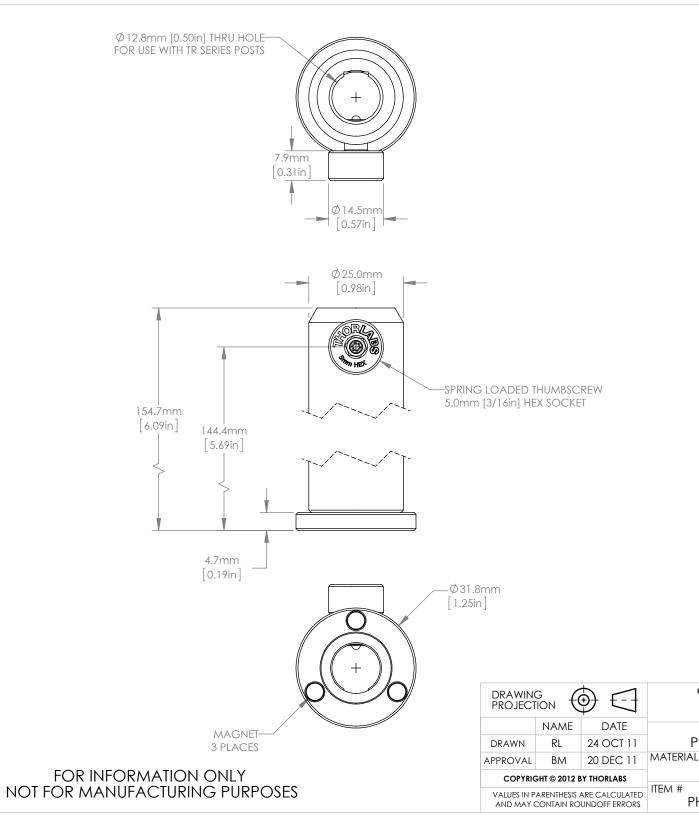
www.thorlabs.com 150mm METRIC PEDESTAL POST HOLDER REV N/A Α APPROX WEIGHT PH150E/M 0.17 kg
